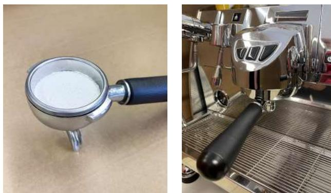
Une fois le rinçage terminé, rincez le porte filtre et reversez-y de la poudre nettoyante puis re-enclenchez celui-ci dans l'autre buse de sortie de la machine.
