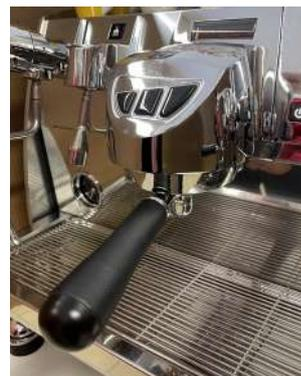
Enclenchez le porte filtre dans l'une des buses de sorties de la machine à café.
