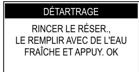
Rincer soigneusement le réservoir et le remplir avec de l'eau fraîche potable jusqu'au niveau MAX indiqué sur l'arrière du réservoir.
