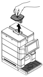
Retirer le couvercle du réservoir à eau.
