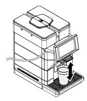
Pour distribuer une boisson à base de lait, toucher l'icône de la boisson à base de lait souhaitée. Si aucune boisson à base de lait n'est visible dans l'écran de sélection des boissons, taper sur l'icône « MILK » à gauche de l'écran de sélection des boissons dans la colonne de commande, puis taper sur l'icône de la boisson à base de lait souhaitée.
