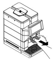
Appuyer sur le bouton situé sur le côté gauche et extraire le Cappuccinatore.
