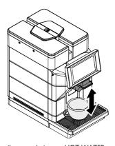
Pour distribuer une boisson « HOT WATER », toucher l'icône de la boisson « HOT WATER » souhaitée. Si la boisson « HOT WATER » n'est pas visible sur l'écran de sélection des boissons, taper sur l'icône « HOT WATER » à gauche de l'écran de sélection des boissons dans la colonne de commande, puis taper sur l'icône de la boisson « HOT WATER » souhaitée.
