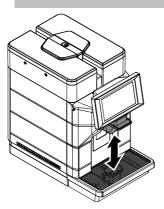
Pour effectuer ce réglage, lever ou baisser la buse de distribution manuellement.
