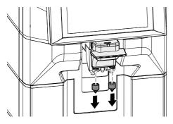
Laver les buses sous l'eau courante en les serrant légèrement. S'assurer que tout dépôt/incrustation de lait a été éliminé. Après le lavage, remonter les composants en suivant la procédure inverse par rapport à celle utilisée pour le démontage.
