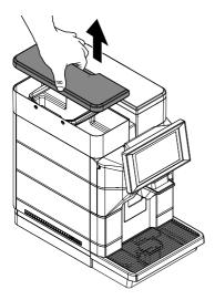
Retirer le réservoir ; le soulever par les poignées prévues à cet effet et installées à l'intérieur.
