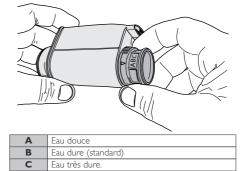
Plonger le filtre à eau verticalement dans l'eau froide (l'ouverture vers le haut) et appuyer délicatement sur les bords pour faire sortir toute bulle d'air.
