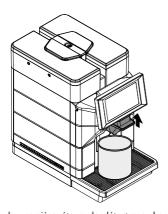
Réaliser la première étape de détartrage. Lorsque la solution à l'intérieur du réservoir est terminée, la machine demande de vider et de rincer le réservoir avec de l'eau fraîche potable. Rincer soigneusement le réservoir et le remplir avec de l'eau fraîche potable jusqu'au niveau MAX indiqué.
