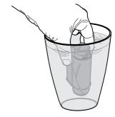
Retirer le réservoir de la machine et le vider. Enlever le petit filtre blanc à l'intérieur du réservoir, le conserver dans un endroit sec et le protéger contre la poussière.
