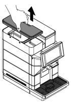
Retirer le réservoir de la machine et le vider. le soulever par les poignées prévues à cet effet et installées à l'intérieur.
