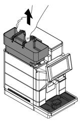
Rincer le réservoir et le remplir d'eau fraîche ; ne pas dépasser le niveau (MAX) indiqué sur le réservoir.
