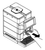
Appuyer sur le bouton situé sur le côté gauche et extraire le Cappuccinatore. (\*uniquement dans les version M2 et M1).
