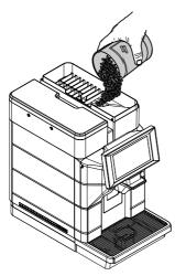
Afin d'éviter toute contamination bactériologique, n'utiliser que des gants stériles à usage unique pour effectuer les opérations de remplissage du réservoir à café.
