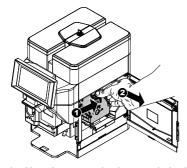
Insérer la tablette de nettoyage dans le groupe de distribution du café et repositionner ce dernier dans la machine, en veillant à réinsérer tous les composants et à fermer le volet.
