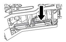
Appliquer la graisse uniformément sur les deux convoyeurs latéraux.
