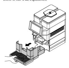
Après l'avoir vidé, réintroduire le bac d'égouttement Insérer le tube d'aspiration propre dans un récipient dans son logement. Placer un grand récipient sous les buses.
