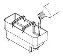
Ajouter de l'eau dans le réservoir jusqu'au niveau «  $\mathsf{CALC}$   $\mathsf{CLEAN}$  ».
