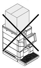
position Étant donné le poids total, il est interdit de superposer plus de trois machines. La machine doit être stockée dans son emballage d'origine dans des lieux NON humides et/ou poussiéreux.
