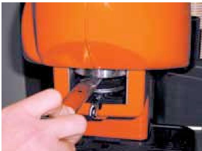
*Fig. 6.1-A Estrazione guarnizione*
