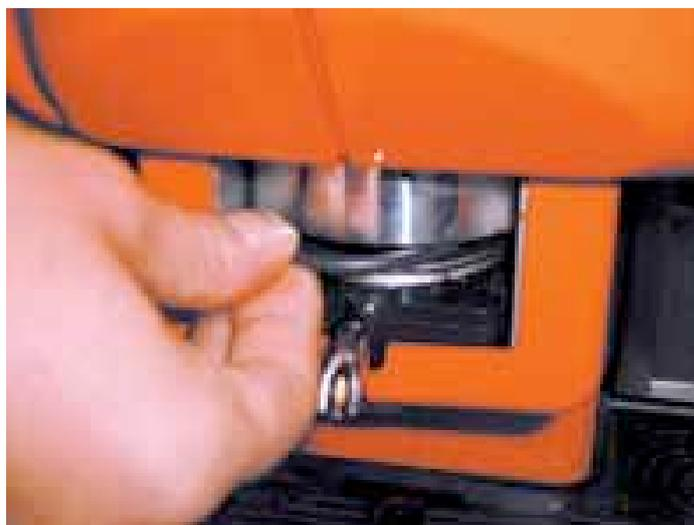
*Fig. 6.1-B Prelievo guarnizione*
