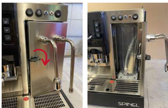
Ouvrez la trappe avec les deux buses pour accéder au bac à eau de la machine. Il n'y a qu'un seul bac pour les deux sorties de café.
