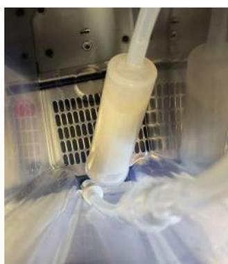
Il est recommandé d'installer un filtre dans cette machine. Cela protège le système et allonge la durée de vie de votre machine.
