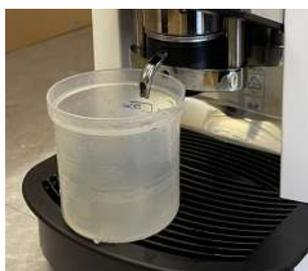
Placez le bol sous la buse de gauche, appuyez sur **A**, laissez actif 5 secondes puis re-appuyez dessus. Patientez 5 secondes et recommencez jusqu'à ce que l'eau coule. Faire la même chose avec la buse de droite. **La machine est maintenant amorcée.**
